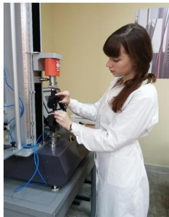
Рис.2 Подготовка к испытанию на разрывной машине
